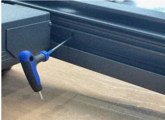
Abbildung 17: Fixierung der Führungsschienen
